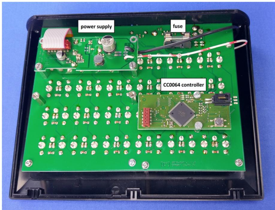
Beim Einschalten erkennt der CC0064 die angeschlossene Schnittstelle RS232 oder USB2.0. Es darf nur eine Schnittstelle gleichzeitig angeschlossen sein.
